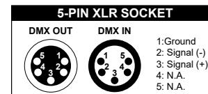
灯具设有标准的 DMX 输入和输出的 3/5 芯 XLR 插，请使用 DMX512 屏蔽双绞信号线。信号线一般连接距离为 150 米，长距离信号传输时，必须加入 DMX512 信号放大器。
