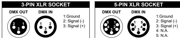
灯具设有标准的 DMX 输入和输出的 3/5 芯 XLR 插，请使用 DMX512 屏蔽双绞信号线。信号线一般连接距离为 150 米，长距离信号传输时，必须加入 DMX512 信号放大器。
