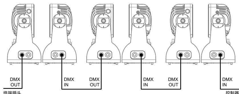
使用一条屏蔽双绞信号线从控制器的 DMX 输出口连接到第一台设备的 DMX 输入口，并从第一台设备的 DMX 输出口连接到第二台设备的 DMX 输入口，依此类推，直到将所有的灯具连接完毕，然后在每一连路的最后一个连接灯具输出 3/5 芯插孔上安装一个终端插头。（在 3/5 芯带针卡侬插头的 2、3 插针之间焊接一个 4/1W、120Ω 的电阻）。
