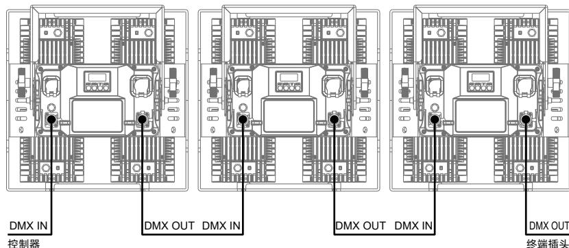
使用一条屏蔽双绞信号线从控制器的 DMX 输出口连接到第一台设备的 DMX 输入口，并从第一台设备的 DMX 输出口连接到第二台设备的 DMX 输入口，依此类推，直到将所有的灯具连接完毕，然后在每一连路的最后一个连接灯具输出 3/5 芯插孔上安装一个终端插头。（在 3/5 芯带针卡依插头的 2、3 插针之间焊接一个 4.1W、120Ω 的电阻）。
