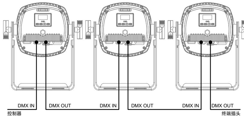
使用一条屏蔽双绞信号线从控制器的 DMX 输出口连接到第一台设备的 DMX 输入口，并从第一台设备的 DMX 输出口连接到第二台设备的 DMX 输入口，依此类推，直到将所有的灯具连接完毕，然后在每一连路的最后一个连接灯具输出 3/5 芯插孔上安装一个终端插头。（在 3/5 芯带针卡侬插头的 2、3 插针之间焊接一个 4/1W、120Ω 的电阻）。
