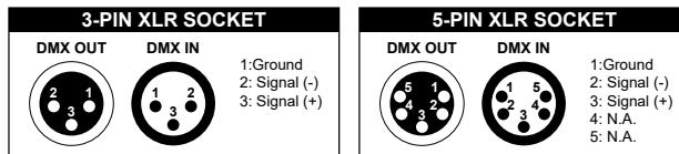
灯具设有标准的 DMX 输入和输出的 3/5 芯 XLR 插，**请使用 DMX512 屏蔽双绞信号线**。信号线一般连接距离为 150 米，长距离信号传输时，必须加入 DMX512 信号放大器。
