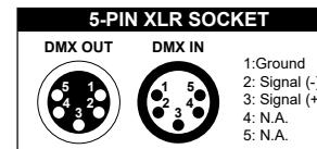
灯具设有标准的 DMX 输入和输出的 3 芯 XLR 插，请使用 DMX512 屏蔽双绞信号线。信号线一般连接距离为 150 米，长距离信号传输时，必须加入 DMX512 信号放大器。
