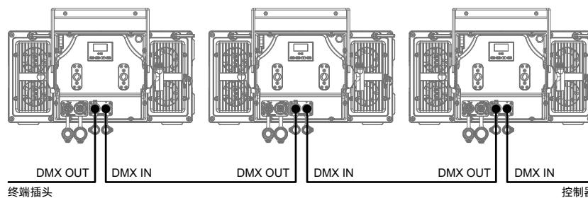
使用一条屏蔽双绞信号线从控制器的 DMX 输出口连接到第一台设备的 DMX 输入口，并从第一台设备的 DMX 输出口连接到第二台设备的 DMX 输入口，依此类推，直到将所有的灯具连接完毕，然后在每一连路的最后一个连接灯具输出 3 芯插孔上安装一个终端插头。（在 3 芯带针卡侬插头的 2、3 插针之间焊接一个 4/1W、120Ω 的电阻）。
