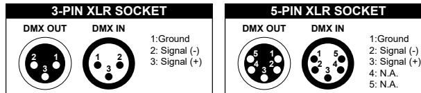
灯具设有标准的 DMX 输入和输出的 3 芯 XLR 插， 请使用 DMX512 屏蔽双绞信号线。信号线一般连接距离为 150 米，长距离信号传输时，必须加入 DMX512 信号放大器。
