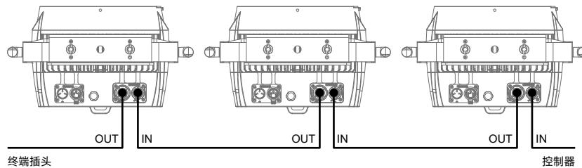
使用一条屏蔽双绞信号线从控制器的 DMX 输出口连接到第一台设备的 DMX 输入口，并从第一台设备的 DMX 输出口连接到第二台设备的 DMX 输入口，依此类推，直到将所有的灯具连接完毕，然后在每一连路的最后一个连接灯具输出 3 芯插孔上安装一个终端插头。（在 3 芯带针卡侬插头的 2、3 插针之间焊接一个 4/1W、120Ω 的电阻）。
