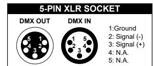
灯具设有标准的 DMX 输入和输出的 3 芯 XLR 插，请使用 DMX512 屏蔽双绞信号线。信号线一般连接距离为 150 米，长距离信号传输时，必须加入 DMX512 信号放大器。
