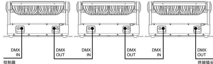
使用一条屏蔽双绞信号线从控制器的 DMX 输出口连接到第一台设备的 DMX 输入口，并从第一台设备的 DMX 输出口连接到第二台设备的 DMX 输入口，依此类推，直到将所有的灯具连接完毕，然后在每一连路的最后一个连接灯具输出 3 芯插孔上安装一个终端插头。（在 3 芯带针卡依插头的 2、3 插针之间焊接一个 4/1W、120Ω 的电阻）。
