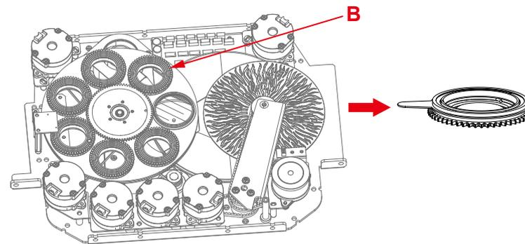
c. 用镊子或其他细小可夹持物把 C 处的卡簧取出 ( 如果图案片涂有玻璃胶用以固定, 请使用专业的清洗剂去除玻璃胶后再取出卡簧, 以免损坏图案片 );
