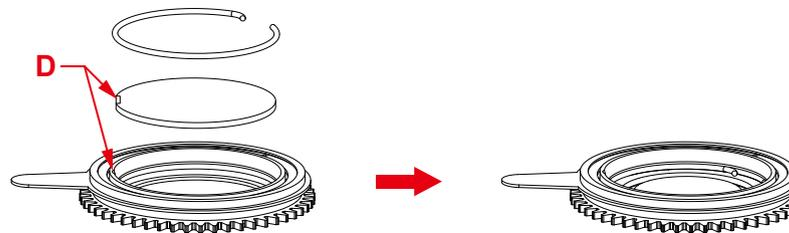
e. 将图案座插入主动轮组件，如 E 所示，图案座按照拆下来的顺序重新安装好；图案座定位点要对准主动轮的定位点；安装完毕后，将图案盘组件装回灯具上即可。
