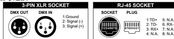
灯具设有标准的 DMX 3 芯 XLR 和 RJ-45 输入和输出插座，请使用 DMX512 屏蔽双绞信号线或 5 类以上网络双绞线连接。DMX 信号线一般连接距离为 150 米，长距离信号传输时，必须加入 DMX512 信号放大器。
