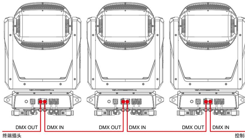
使用一条屏蔽双绞信号线从控制器的 DMX 输出口连接到第一台设备的 DMX 输入口，并从第一台设备的 DMX 输出口连接到第二台设备的 DMX 输入口，依此类推，直到将所有的灯具连接完毕，然后在每一连路的最后一个连接灯具输出 3 芯插孔上安装一个终端插头。（在 3 芯带针卡侬插头的 2、3 插针之间焊接一个 4/1W、120Ω 的电阻）。
